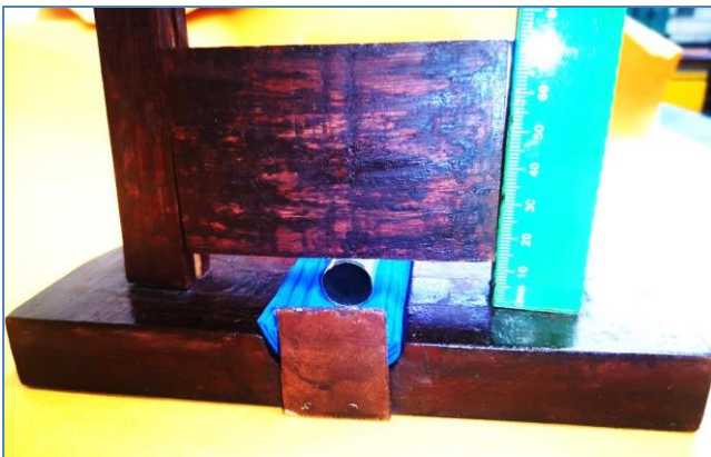
Imágenes 21 y 22 Antes y después del análisis de equivalencia en dureza de tubos colapsibles.
