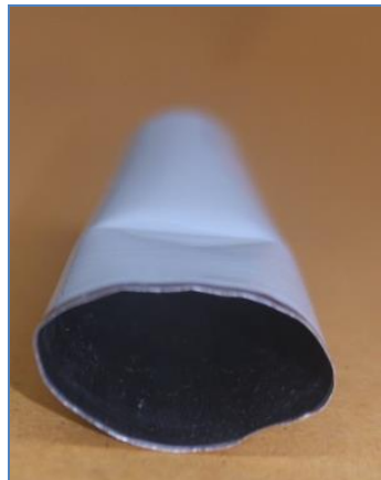
Imágenes 23,24,25 Deformación plástica de menor a mayor grado.
