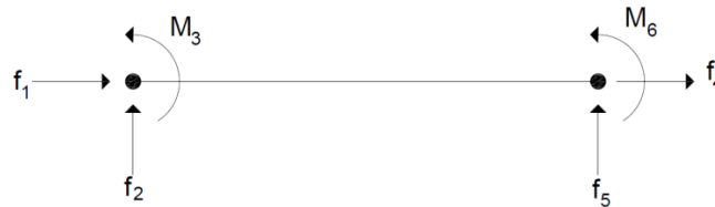
Figura 2.4. Sistema de fuerzas aplicadas en los nodos de un elemento viga.
