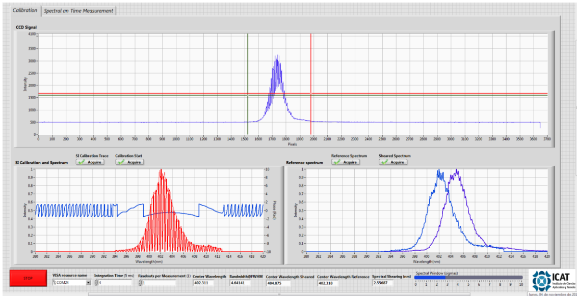
Figura 5-10.-Ventana inicial del sistema ZAP-SPIDER. La primera sección muestra la imagen obtenida en el sensor CCD lineal del espectrómetro. Las ventanas inferiores muestran los datos necesarios para la calibración del instrumento (espectros de referencia, espectro con el corrimiento, traza de calibración, etc).
