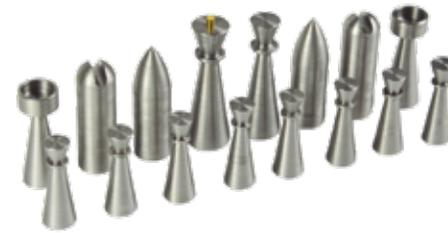
Figura 1.36 Ajedrez de acero inoxidable maquinado en un Torno CNC
