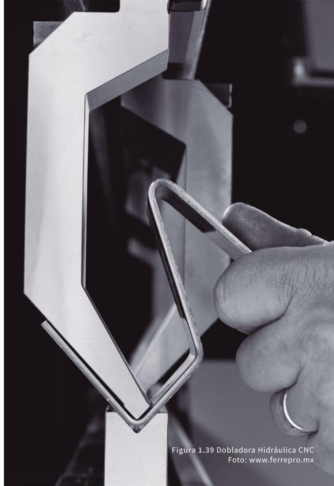
Figura 1.39 Dobladora Hidráulica CNC
