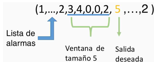
Figura 4.5: Representación del vector de alarmas, una ventana de longitud o tamaño 5 y su respectiva salida deseada o target .
