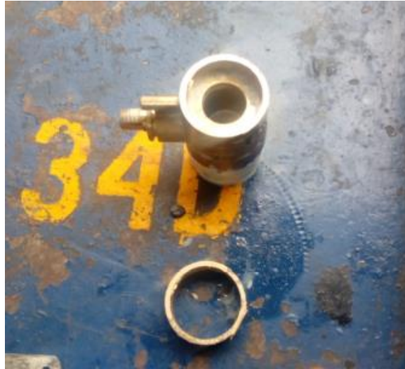
Figura 3.1.1 Válvula de bola después de ser cortada.
