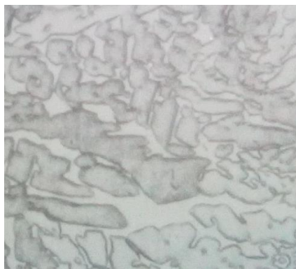
Figura 3.1.3 Imagen de bronce al zinc 210X obtenido de Metals Handbook para aleación C28000.[18]
