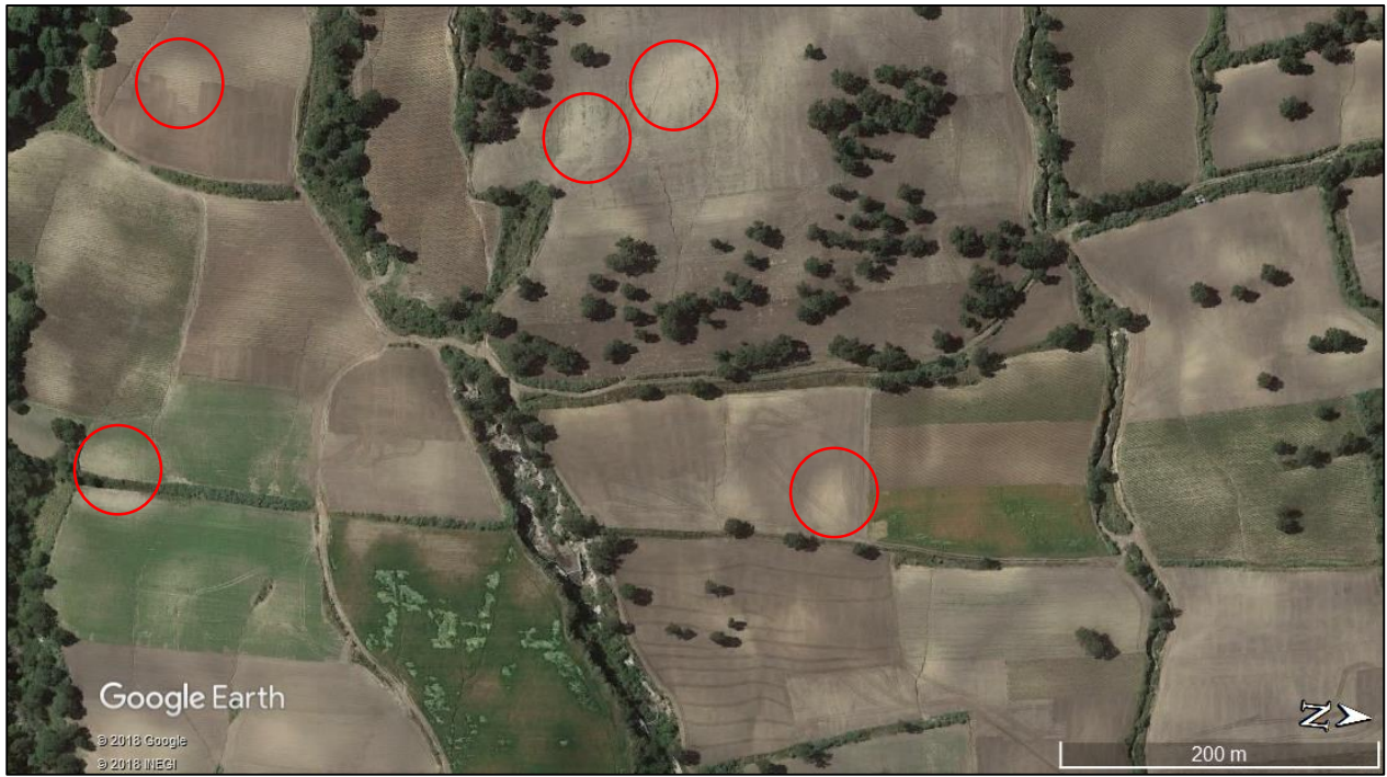
Figura 8.1. Parches claros en la superficie del terreno dónde probablemente se ha perdido el horizonte superficial del suelo (círculos rojos). Imagen de Google (2018).
