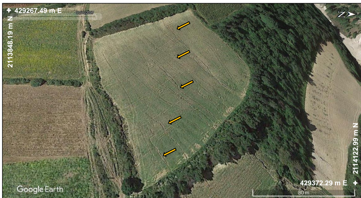
Figura 6.3. Desarrollo de surcos erosivos paralelos sobre un campo de cultivo ligeramente escarpado en la cuenca media, imagen satelital del año 2017 (Google, 2018). Las flechas amarillas señalan los surcos.
