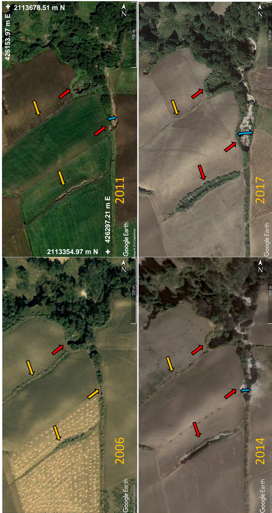
Figura 6.6. Evolución de surcos erosivos a cárcavas y barrancos, en imágenes satelitales de diferentes años: 2006, 2011, 2014 y 2017 (Google, 2018). Las flechas amarillas señalan los surcos erosivos mientras que las flechas rojas señalan las cárcavas y las flechas azules indican el lugar de medición del ancho de la cárcava.
