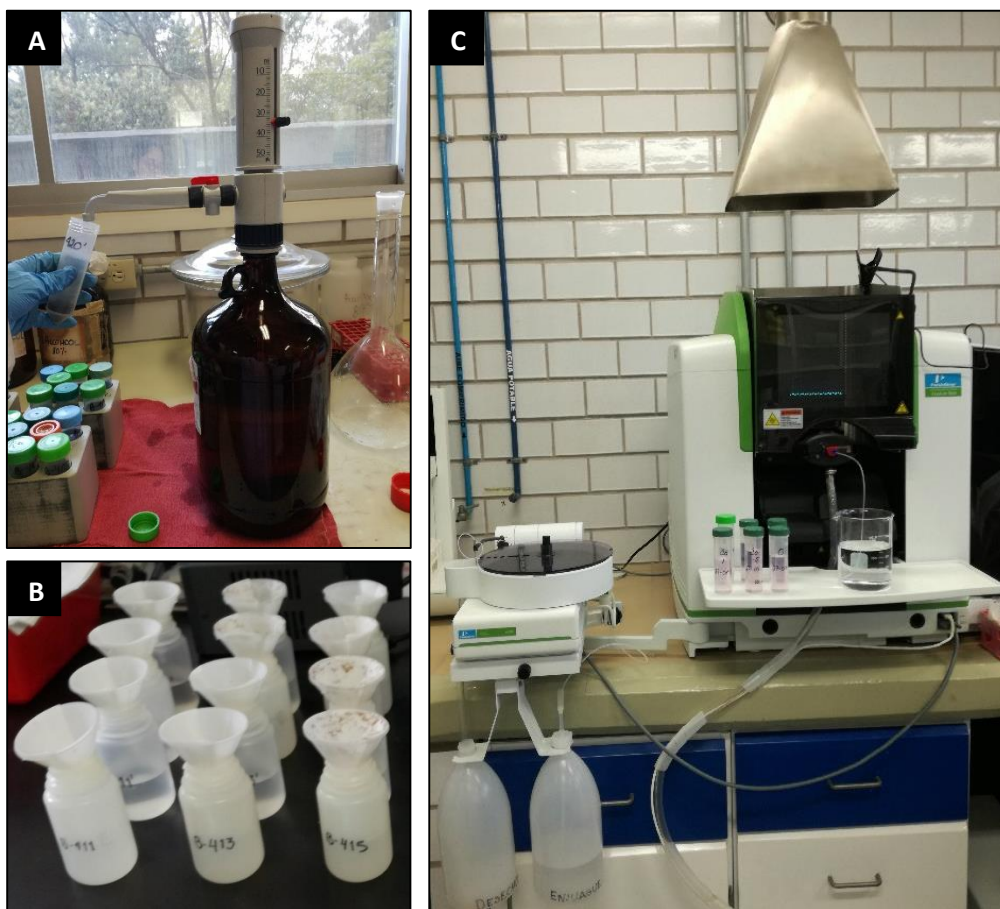
Figura A.8. Agregando acetato de amonio a las muestras con pipeta (A). Extractos de muestras con embudos, papel filtro y envases de plástico (B). Espectrofotómetro de absorción atómica para determinar \text{Ca}^{2+} y \text{Mg}^{2+} (C).
