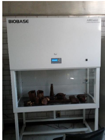
Figura 25 Esterilización de material en campana de flujo laminar
