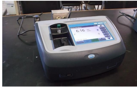
El espectrofotómetro Hach mr DR3900 para medir las muestras de nitratos, nitritos y amoniaco.
