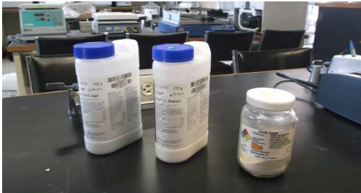
Medios de cultivo para Coliformes Fecales y Coliformes Termotolerantes: ° Difco mr m FC Agar ° Difco mr m EC Medium
