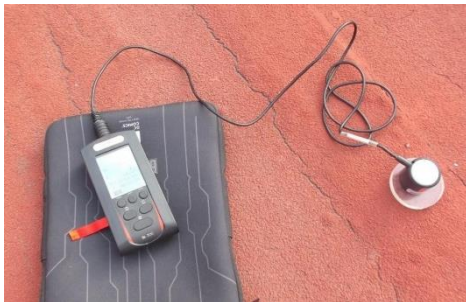
Sensor de radiación solar KIMO Instruments mr SL200, calibrado a generar lecturas cada minuto.
