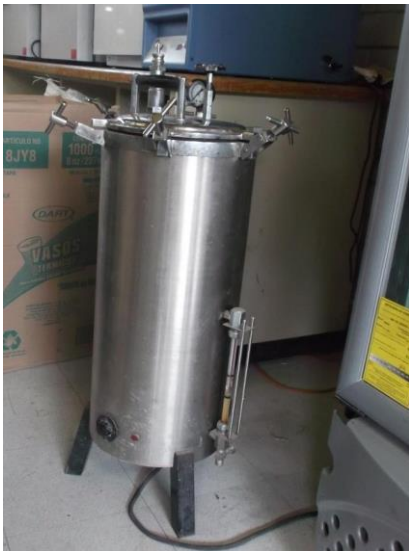
Autoclave Corpor mr SU ML para esterilizar el material
