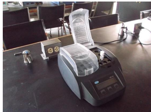
Termoreactor Hach mr DRB200 para la preparación de muestras de materia orgánica e inorgánica.
