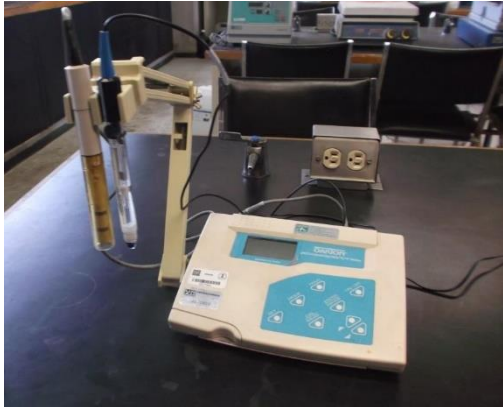
Medidor de pH OAKTON mr 510, para medir el índice de acidez de la muestra.
