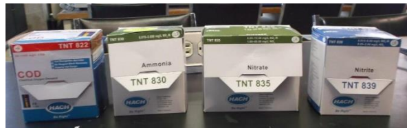
Reactivos de evaluación: ° Hach mr TNT 822 DQO ° Hach mr TNT 830 amoniaco ° Hach mr TNT 839 Nitrito ° Hach mr TNT 835 Nitrato
