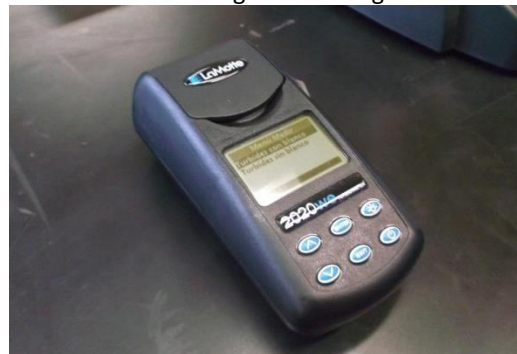
Turbidímetro La Motte mr 2020We para determinar el índice de partículas en la muestra.
