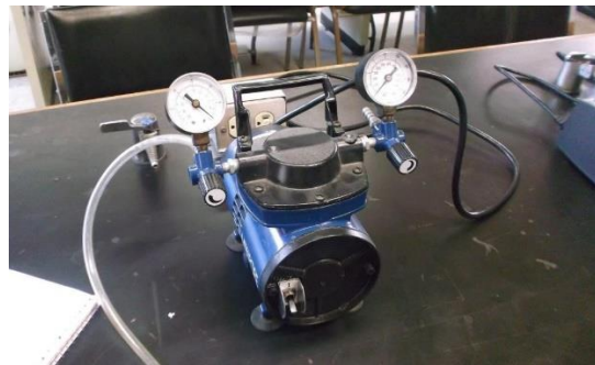
Bomba de vacío Millipore mr WP6111560 para extraer el agua de las colonias de coliformes fecales y coliformes termotolerantes.
