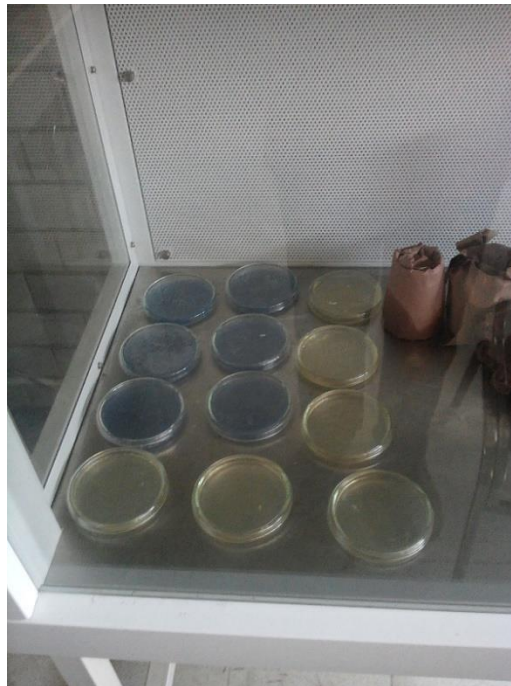
Figura 27 Preparación de caldos para coliformes fecales y coliformes termotolerantes
