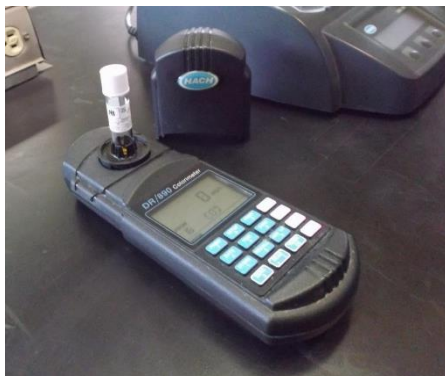
Colorímetro Hach mr DR/890 para la medición de muestras de materia orgánica e inorgánica.
