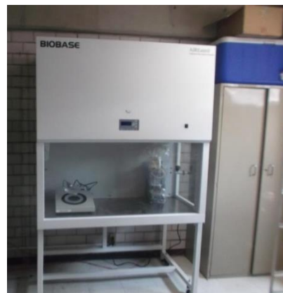
Campana de flujo laminar AIREsteril mr Para la elaboración de cultivos y conteo de colonias.
