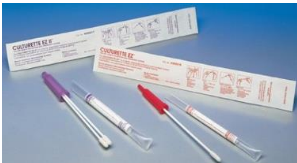
Figura 15. Sistema Culturette®, que incluye un frasco ampolla o una cámara separada por una membrana que contiene sustancias químicas que generan catalizadores de CO 2 y desecantes para capturar el O 2 residual que pueda quedar dentro del sistema. Contiene un hisopo de poliuretano estéril. Para usarlo, todo lo que se debe hacer es quitar el hisopo, recoger la muestra y devolver el hisopo y la tapa al tubo.
