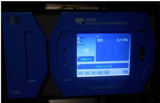
Figura 4.11. Analizador de SO<sub>2</sub> T100
