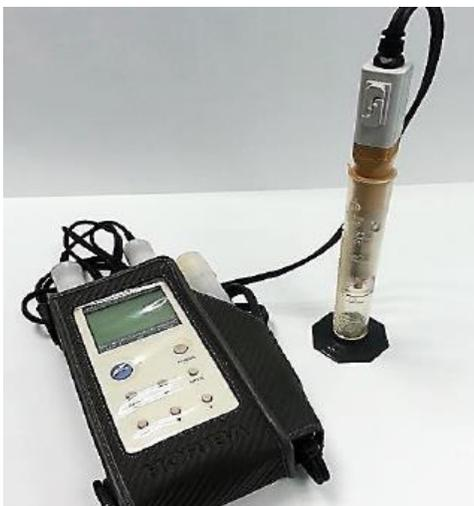
Figura 4.8 Conductímetro Horiba 580
