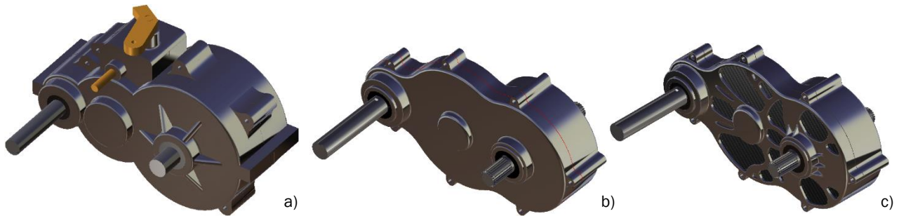
FIGURA 7.5 Comparación de la carcasa izquierda original y la optimizada topológicamente.
