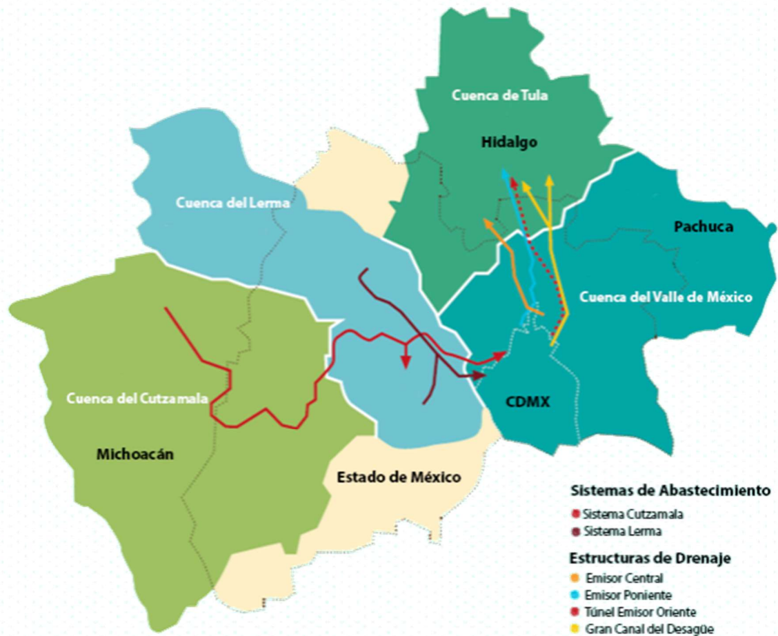
Ilustración 11 Sistema de Abastecimiento y de Drenaje para el Valle de México. Fuente: Aguirre, 2012
