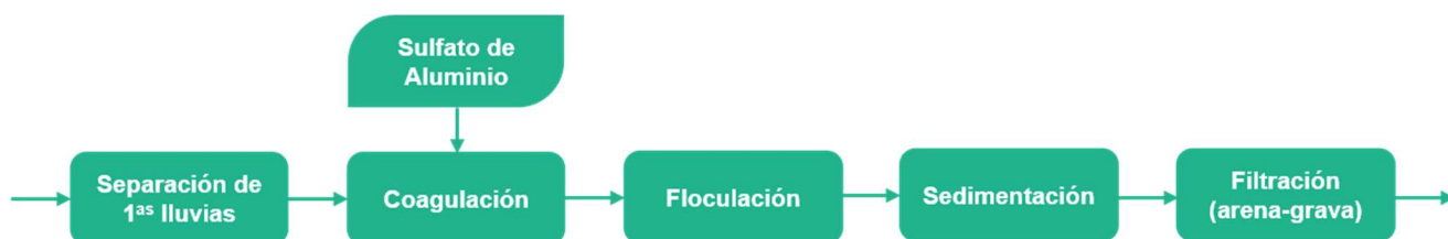
Ilustración 36 Tren de tratamiento primario 1
