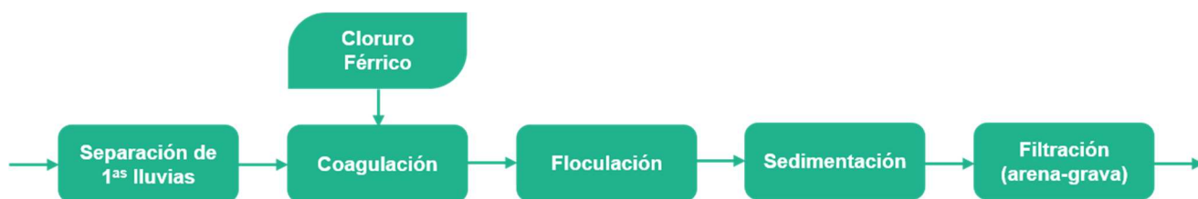
Ilustración 37 Tren de tratamiento primario 2
