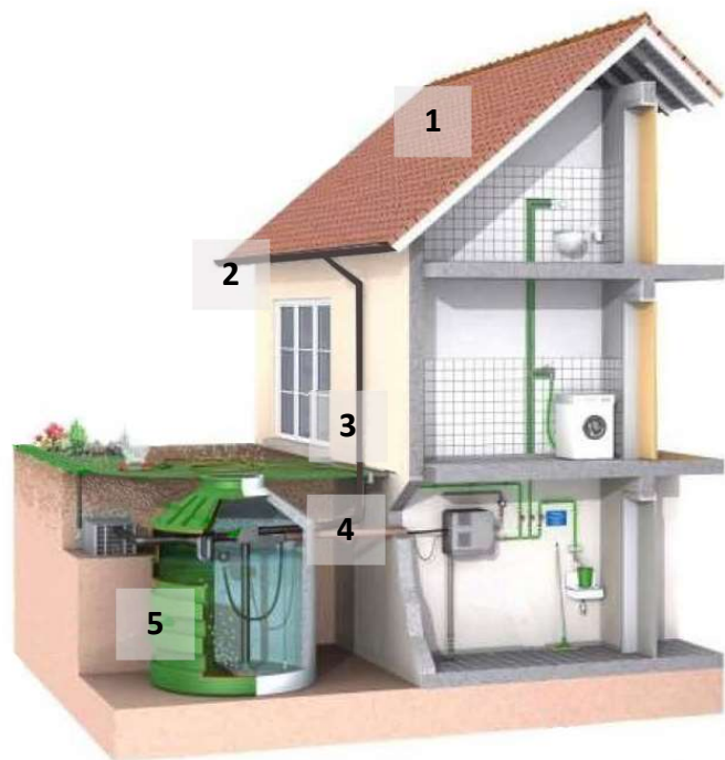
Ilustración 22 Sistema de Captación de Agua de Lluvia
