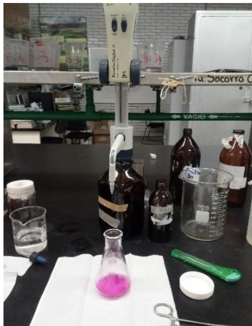
Figura 17. Titulación de KOH 0.5 N con HCl de normalidad conocida con fenofaleína como indicador, a las 48h de incubación.
