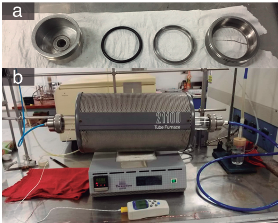
Figura 2.1: a) Tapas para tubo de síntesis y b) Horno para síntesis con termómetro anexo para medir mejor la temperatura.
