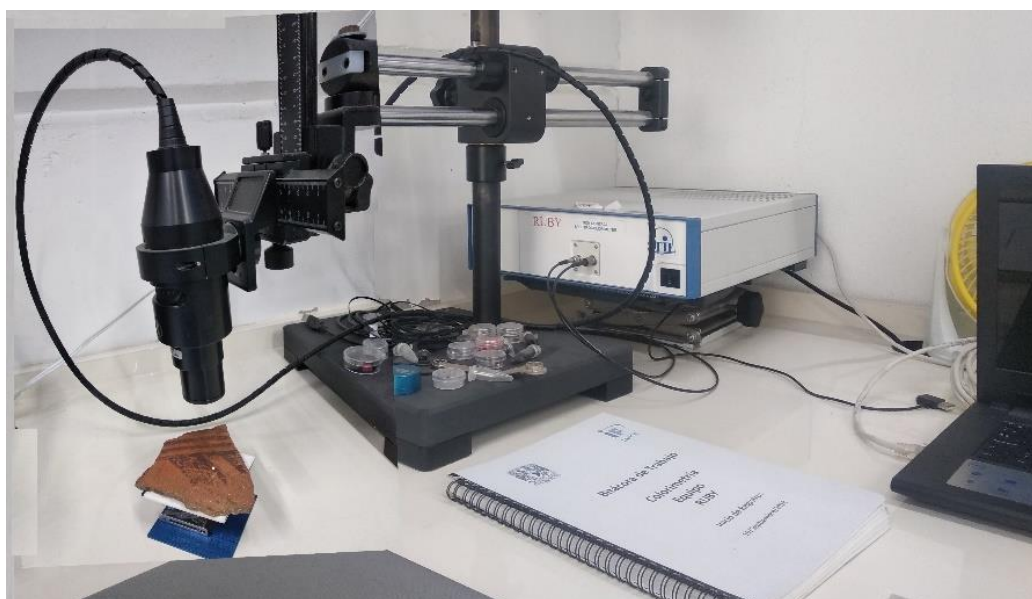
Foto 15. Instrumento para la medición del color. Espectrocolorímetro _ Ruby_ LANCIC-IF-UNAM
