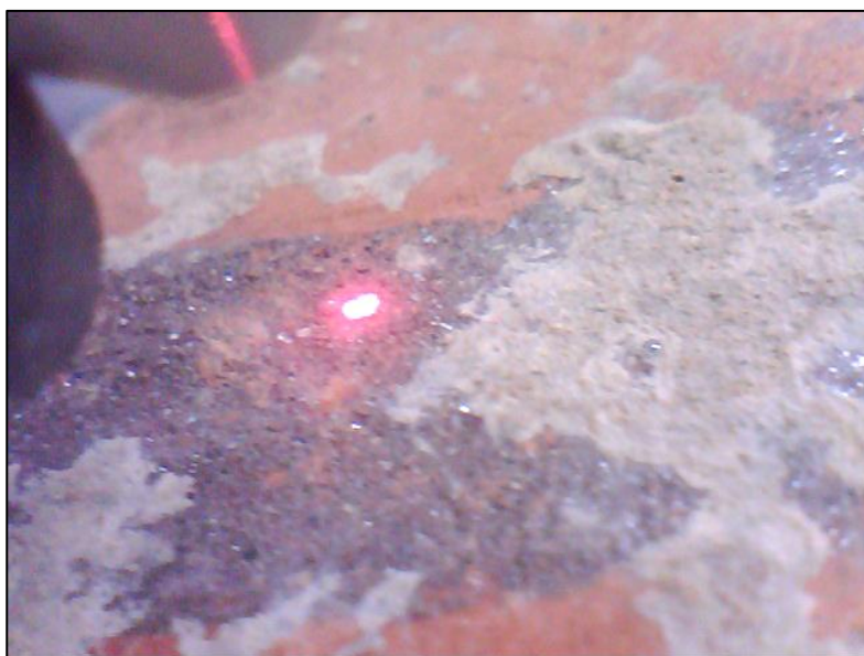
Foto 20. Detalle de uno de los puntos para la adquisición de los espectros FRX sobre el pigmento. Muestra 1.
