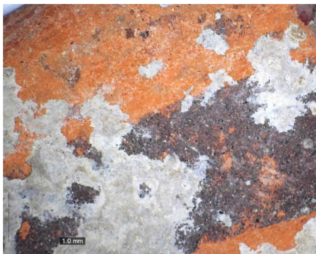
Foto 24. Se observa la formación de carbonatos que causan el craquelado en la pintura. Muestra 1, sitio (SON:E:13:6), bolsa 36041
