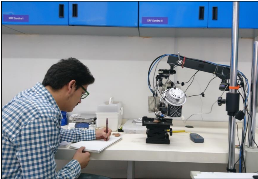
Foto 19. Proceso de toma de lecturas de FRX sobre el pigmento trincheras, con el equipo SANDRA- LANCIC-IF-UNAM- 2018.
