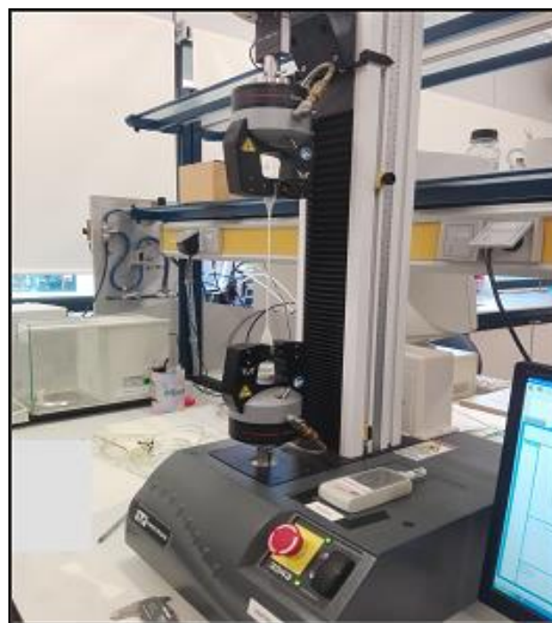
Figura 5.11. Ejemplo del ensayo realizado de esfuerzo-deformación para un PUI flexible.
