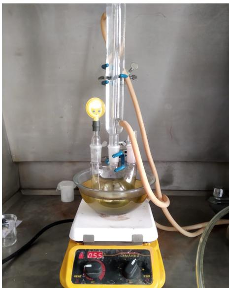
Fig. 5.2 Sistema empleado en la síntesis de óxido de grafito
