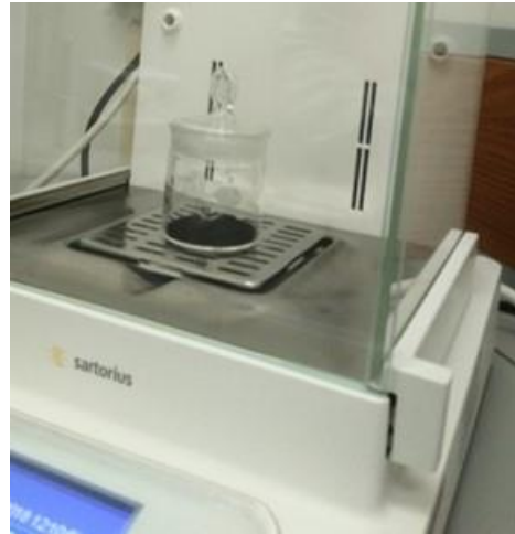
Figura 43. Pesado de muestras de carbón mineral una vez se realizó el atemperamiento dentro del desecador con perclorato de magnesio.
