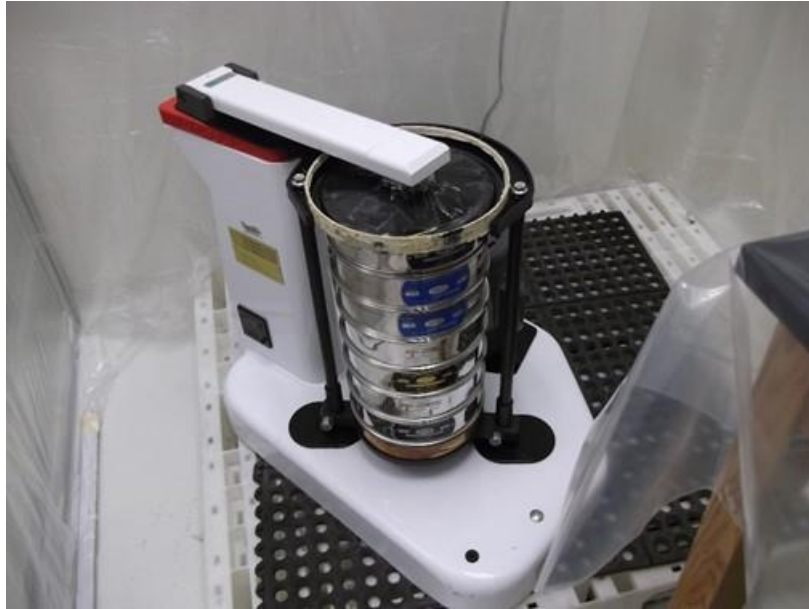
Figura 6. Configuración de torre de tamices y tamizador de polvos Tyler.
