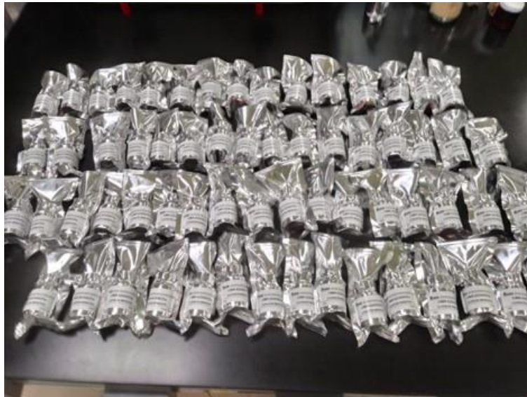
Figura 34. Producción de materiales candidato a material de referencia de carbón mineral.
