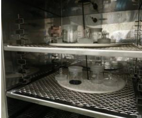
Figura 42. Secado en estufa de muestras de carbón mineral a 107 °C.
