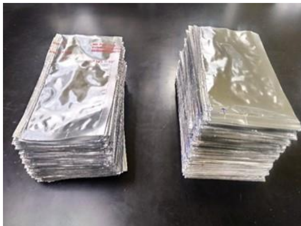
Figura 29. Bolsas aluminizadas de tereftalato de polietileno o Mylar® para el sellado al vacío de los frascos.
