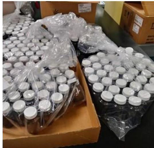
Figura 21 y Figura 22. Secado de material en estufa a 80 °C (izquierda) y material limpio con tapas después de someter a estufa (derecha).
