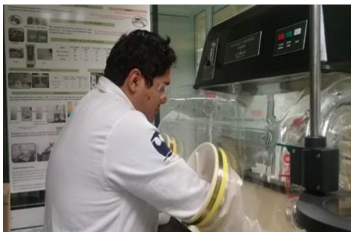
Figura 25. Envasado de carbón mineral en cámara de ambiente controlado bajo atmósfera de argón.
