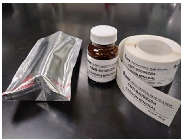
Figura 30. Bolsa aluminizada de tereftalato de polietileno (Mylar®).
