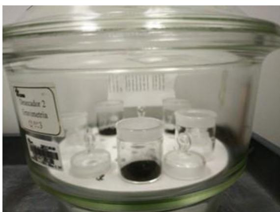
Figura 40. Secado de muestras de carbón mineral de la botella 98.
