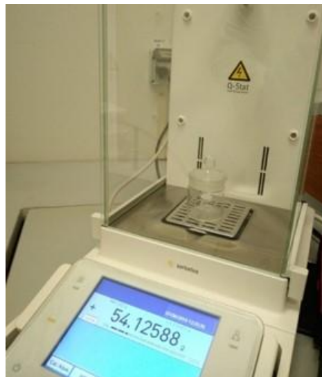
Figura 37. Pesado de pesafiltros vacíos en la balanza Sartorius.
