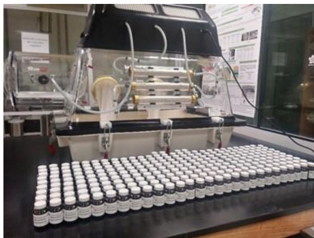
Figura 28. Etiquetado de lote de 256 unidades de candidato a material de referencia de 20 g de carbón mineral.
