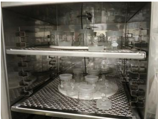
Figura 36. Secado en estufa de pesafiltros de borosilicato.
