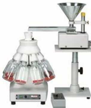
Figura 11. Divisor simple con alimentador vibratorio acoplado marca Fritsch.
