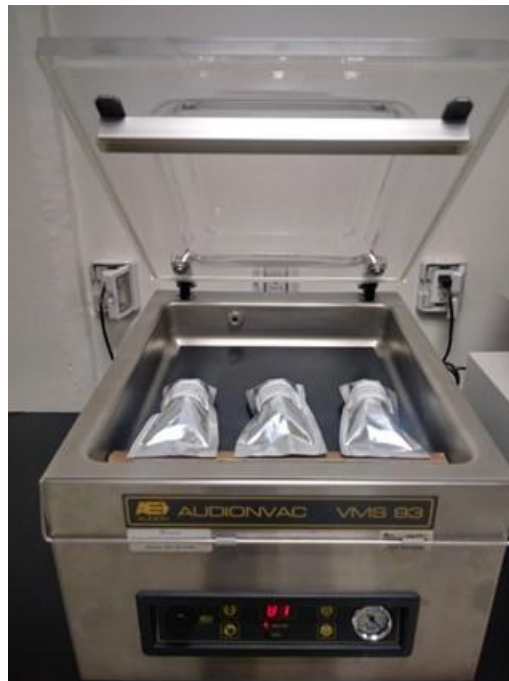
Figura 32. Sellado al vacío de los frascos con carbón mineral en la selladora al vacío AudioVac 93.
