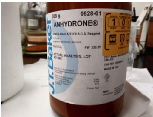
Figura 38. Agente desecante de Perclorato de Magnesio para el secado.
