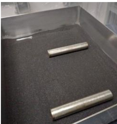
Figura 10. Molienda de carbón mineral en charola de acero.
