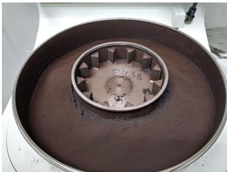
Figura 13. Apariencia del carbón mineral molido en el Pulverisette 14.
