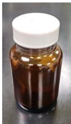
Figura 26. Material candidato a material de referencia envasado bajo atmósfera inerte y sellado con termoplástico.
