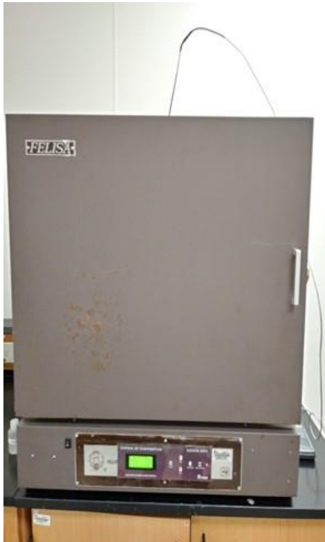
Figura 21 y Figura 22. Secado de material en estufa a 80 °C (izquierda) y material limpio con tapas después de someter a estufa (derecha).
