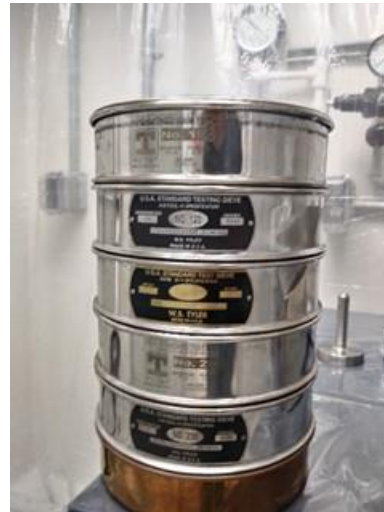
Figura 4. Arreglo de tamices que será usado para el tamizado 1 (izquierda) y
