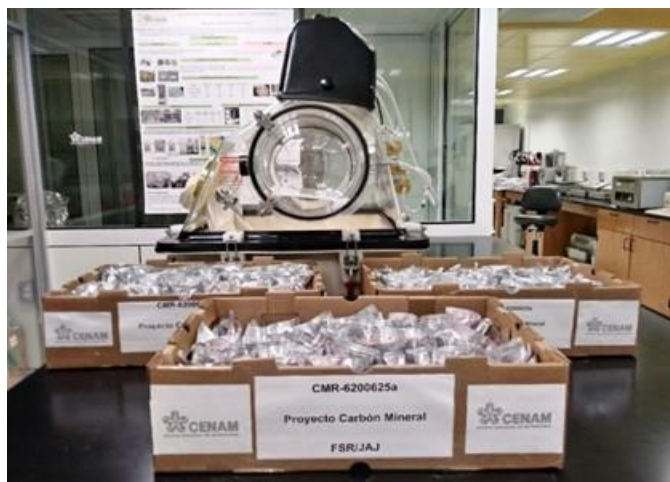
Figura 35. Lote producido de 256 unidades de candidato a material de referencia de carbón mineral de 20 g cada uno en frascos de vidrio ámbar y en bolsa aluminizada de tereftalato de polietileno (Mylar®) al vacío.
