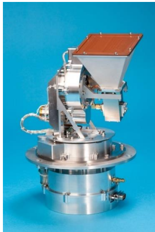
Figura 67 Antena en banda X de alta ganancia y sistema de apuntamiento de Surrey. [53]
