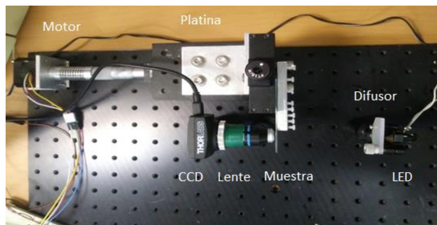
Figura 10 Configuración real del arreglo experimental implementado.
