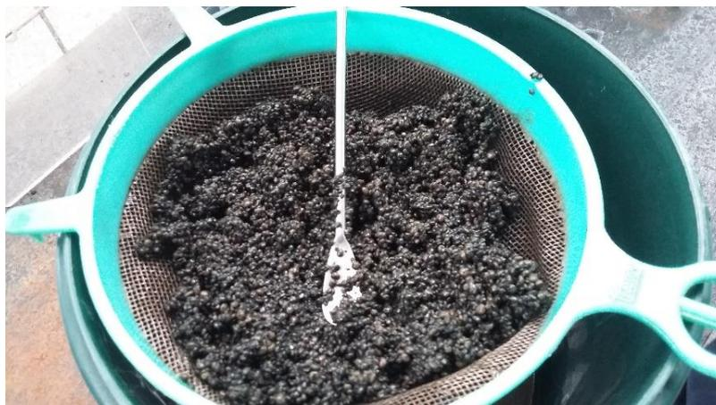
Figura 5.3. Lodo granular anaerobio
