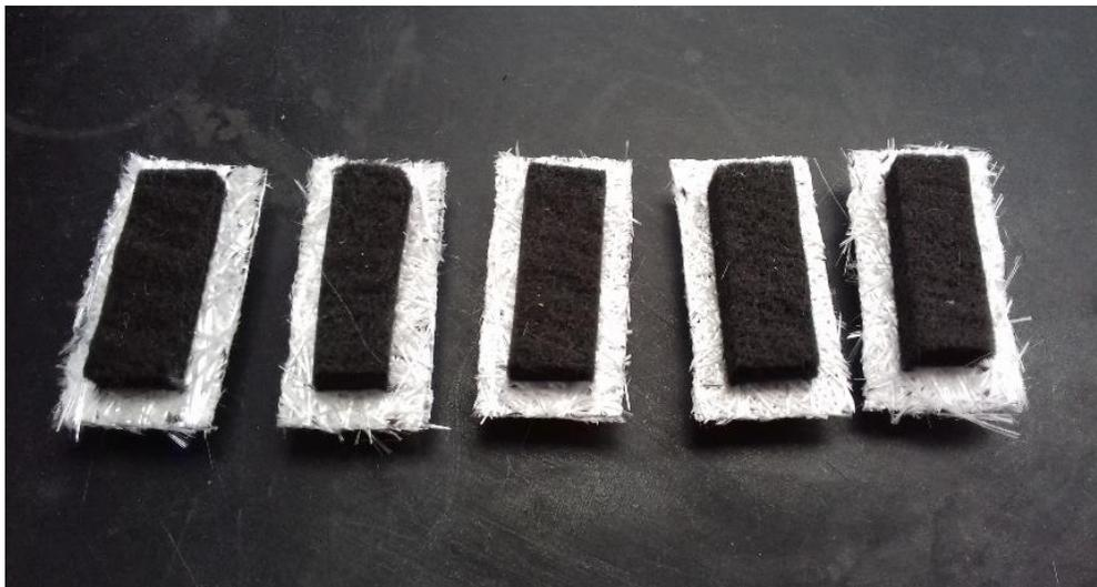
Figura 5.6. Electrodos de felpa de grafito separados con fibra de vidrio
