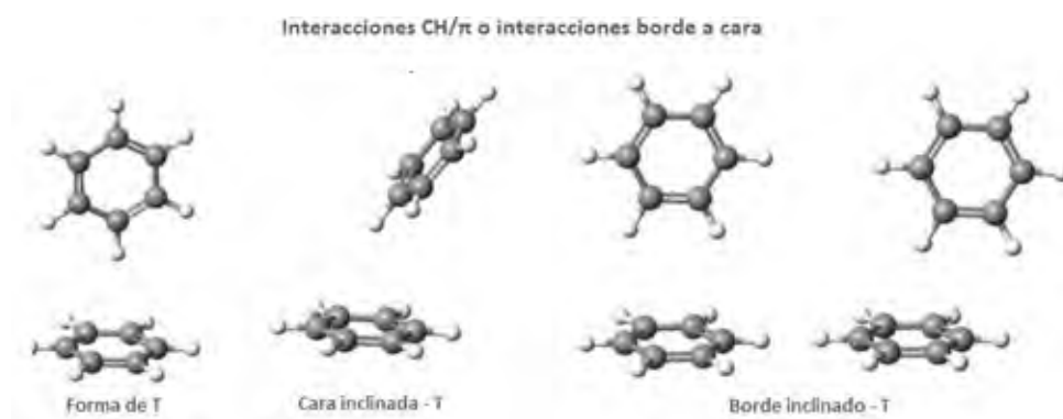
Figura 9. Diferentes geometrías de interacciones C – H \cdots \pi : Forma de T, cara inclinada - T y borde inclinado - T [17].
