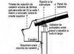
DETALLE CANALÓN DET-A DET-B Placa de fijación con 2 o 4 pías automáticas de 2" x 2" de diámetro. Tapaderas tipo con pías automáticas de 2" x 2" con arandela plástica a cada 1.5m en forma alternada. DETALLE UNIÓN DE PANELES
