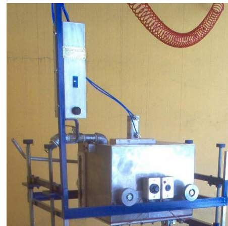
Ilustración 32. Maquina llenadora de parafina liquida de 20 boquillas "Valner"
