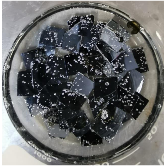
Figura 59. Tratamiento de las obleas de Si con la disolución piraña.
