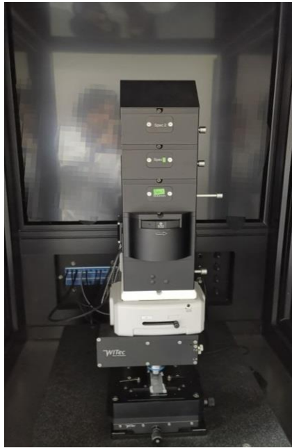
Figura 21. Obleas de SiO 2 /Si con gotas de 10 \mu L de AC, GOPM, rGO12, rGONP12, rGO20 y rGONP20 (arriba) y el microscopio acoplado al Raman WITec (abajo).
