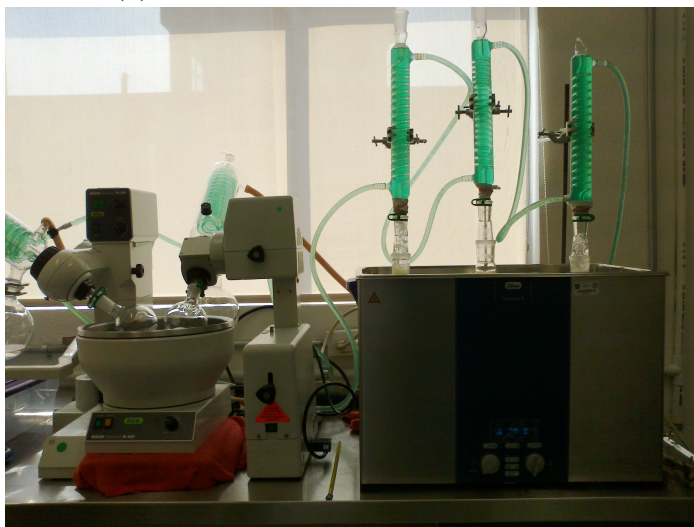
(b) Sistema de extracción asistido por ultrasonido con celda de vidrio y “rota-evaporador” para reducción del volumen de muestra
