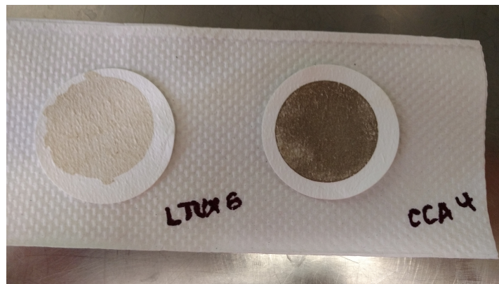
(e) Filtros con material particulado resultado del proceso de pre-filtración de los extractos obtenidos. Izq: Los Tuxtlas, Der: Centro de Ciencias de la Atmósfera
