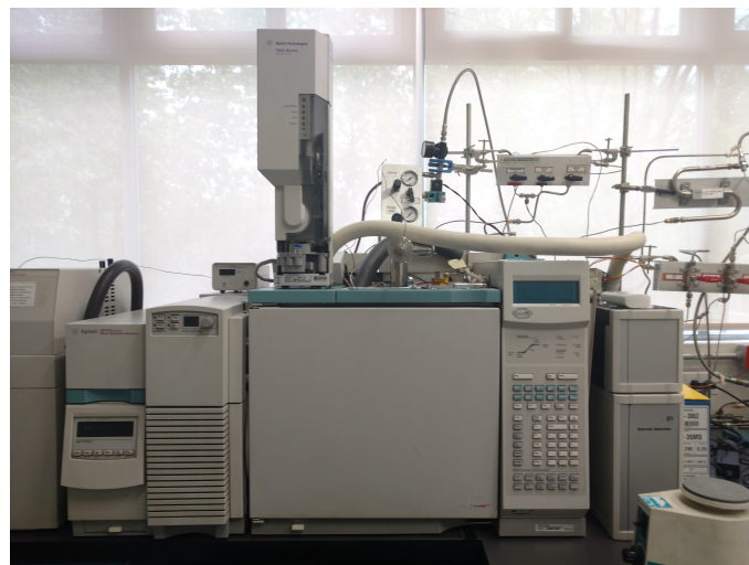
(f) Cromatógrafo de gases acoplado a espectrómetro de masas para el análisis de los extractos (Agilent 6890/5973N)
