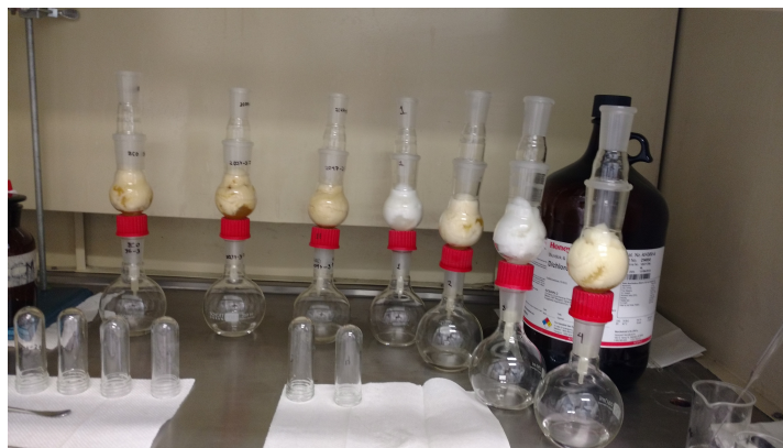
(c) Colecta de extracto posterior al proceso de sonicación
