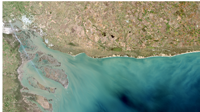
Figura 2.2: Recorte de imagen satelital Landsat 8, visualizada en color verdadero. Combinación de las bandas 4,3,2.
