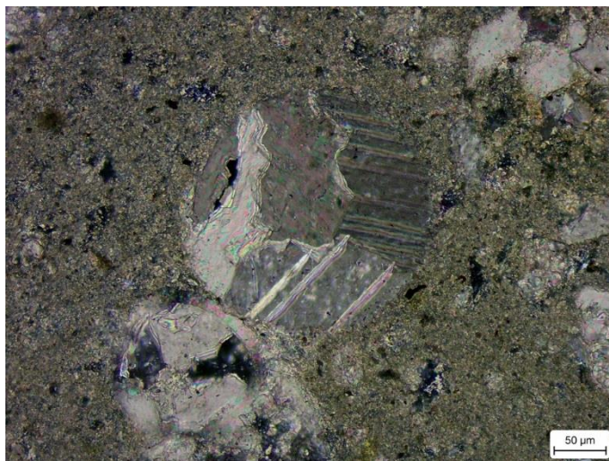
Fotomicrografía 10 Lamina delgada de la muestra MTZ-05, objetivo 5x y Nx. Calciesfera con calcita intrapartícula, se observa sobrecrecimiento.
