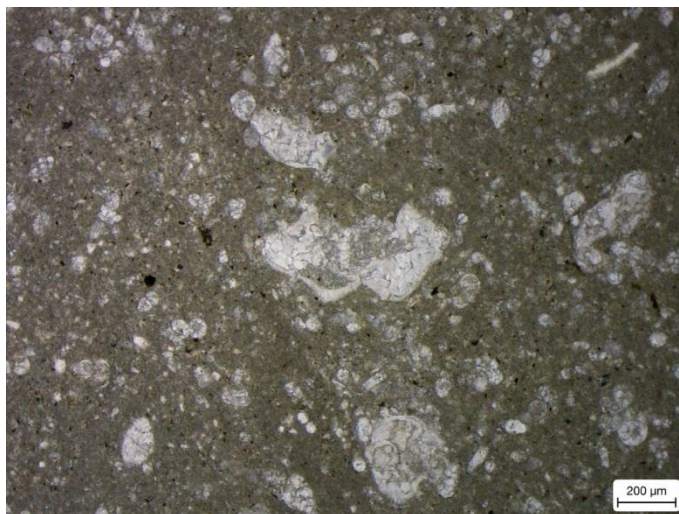
Fotomicrografía 9 Lamina delgada de la muestra MTZ-05 , objetivo 5x y LP. Se puede observar fauna pelágica.
