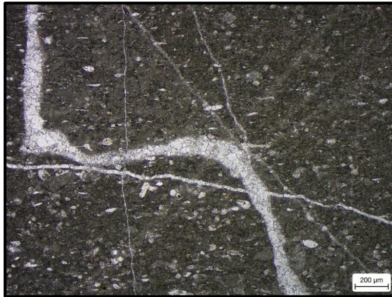
Fotomicrografía 43 Sección delgada MTZ-P5 tomada con objetivo 5x y Lp. Se puede observar estructura Burrow.
