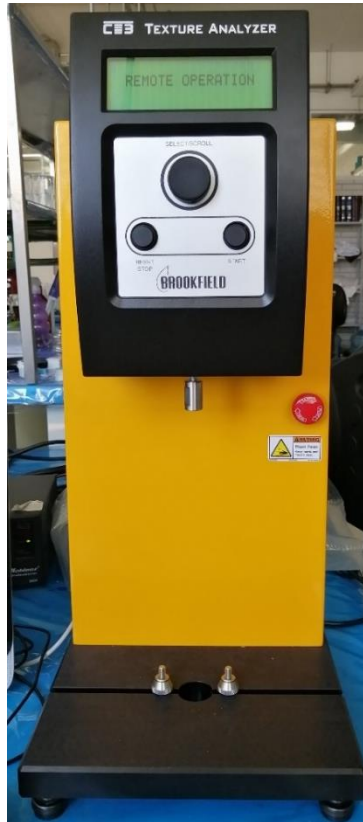
Figura 32. Texturómetro Brookfield CTB Texture Analyzer.
