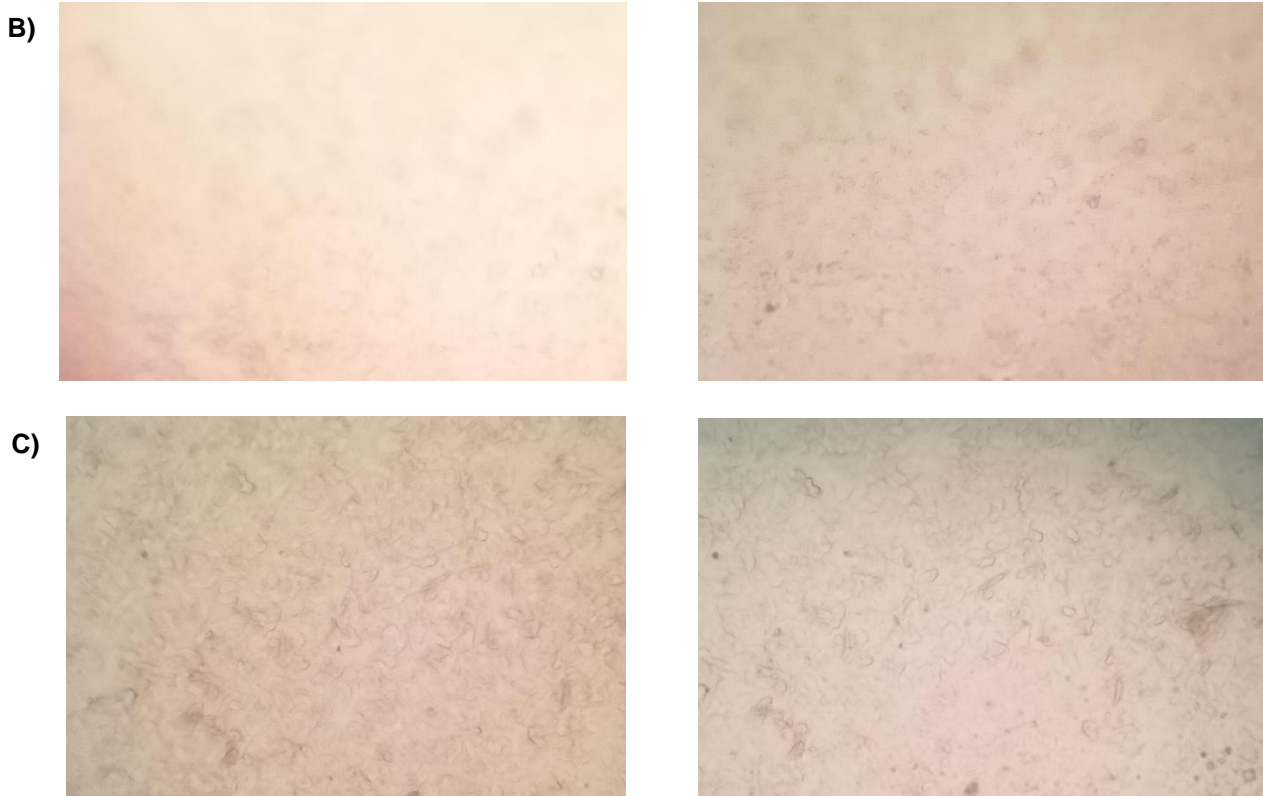
Figura 52. Observaciones del parche transdérmico de Glibenclamida bajo microscopía óptica. En la figura se observa una muestra del parche transdérmico de glibenclamida bajo el objetivo de 40x a los: a) 10 días de elaboración, b) 30 días de elaboración y c) 90 días de elaboración.
