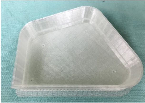
Figura 47. Impresión 3D a escala 1:2 de la pieza "Envolvente 2" en PLA transparente
