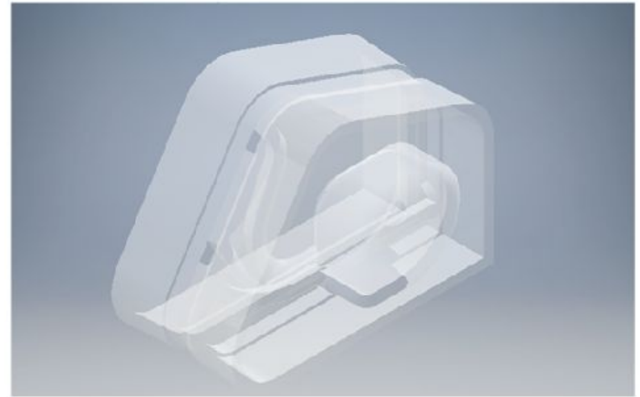
Figura 46. Vista isométrica: Modelado 3D de la pieza "Envolvente 1" y "Envolvente 2" del simulador de drenaje vesical en material translúcido (silicón).
