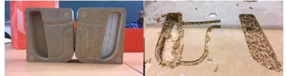
Figura 39. Modelos de MDF 15mm con Router de Control Numérico. Escala 1:1
