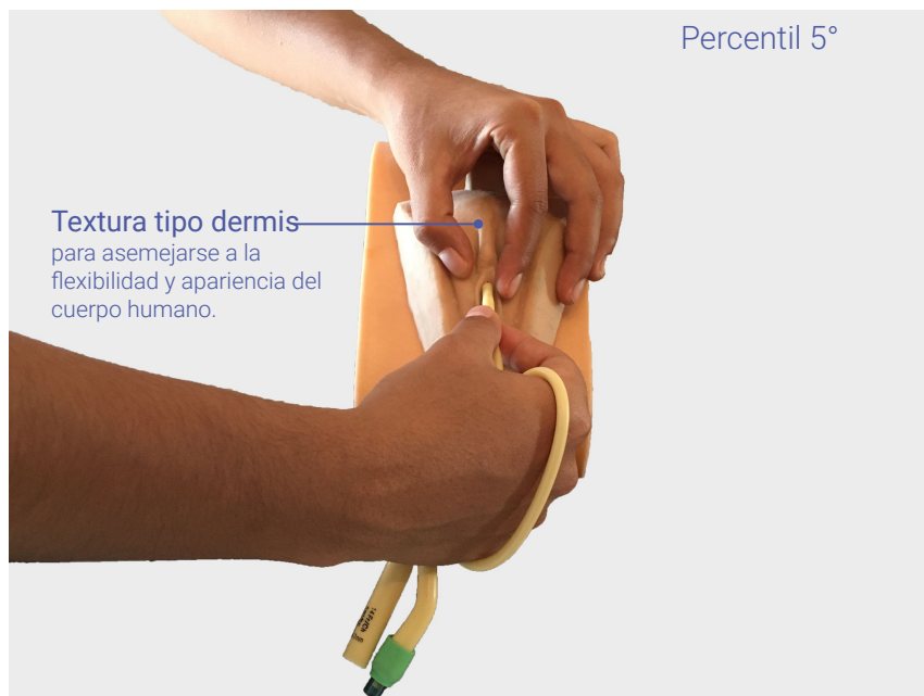
Figura 83 y 84. Vista frontal del simulador al momento de introducir la sonda foley.
