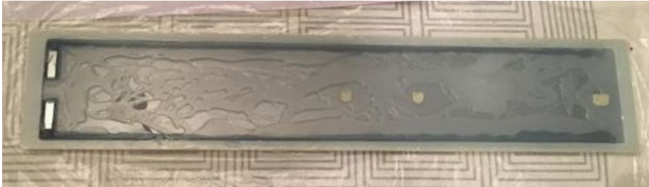
Figura 95. Prueba de vaciado de silicón sin pigmento.
