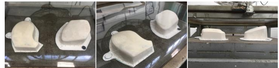
Figura 36. Modelos de Alternativas 3 y 4 en espuma de poliuretano con pasta automotiva para proceso de Termoformado. Escala 1:1
