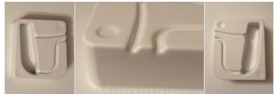
Figura 40. Termoformado con estireno calibre 80. Escala 1:1
