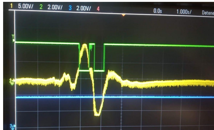
Figura 60. Comportamiento de curva S obtenida electrónicamente (señal Amarilla), respecto a señal de salida del comparador diseñado (señal Verde). Señales adquiridas en el osciloscopio TEKTRONIX.
