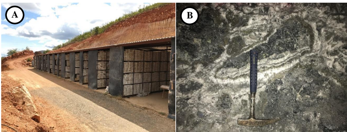
Figura 10. A) Almacén de núcleos de barrenos de la empresa Don David Resource Gold . B) Obra minera nivel 20, veta Splay 5.
