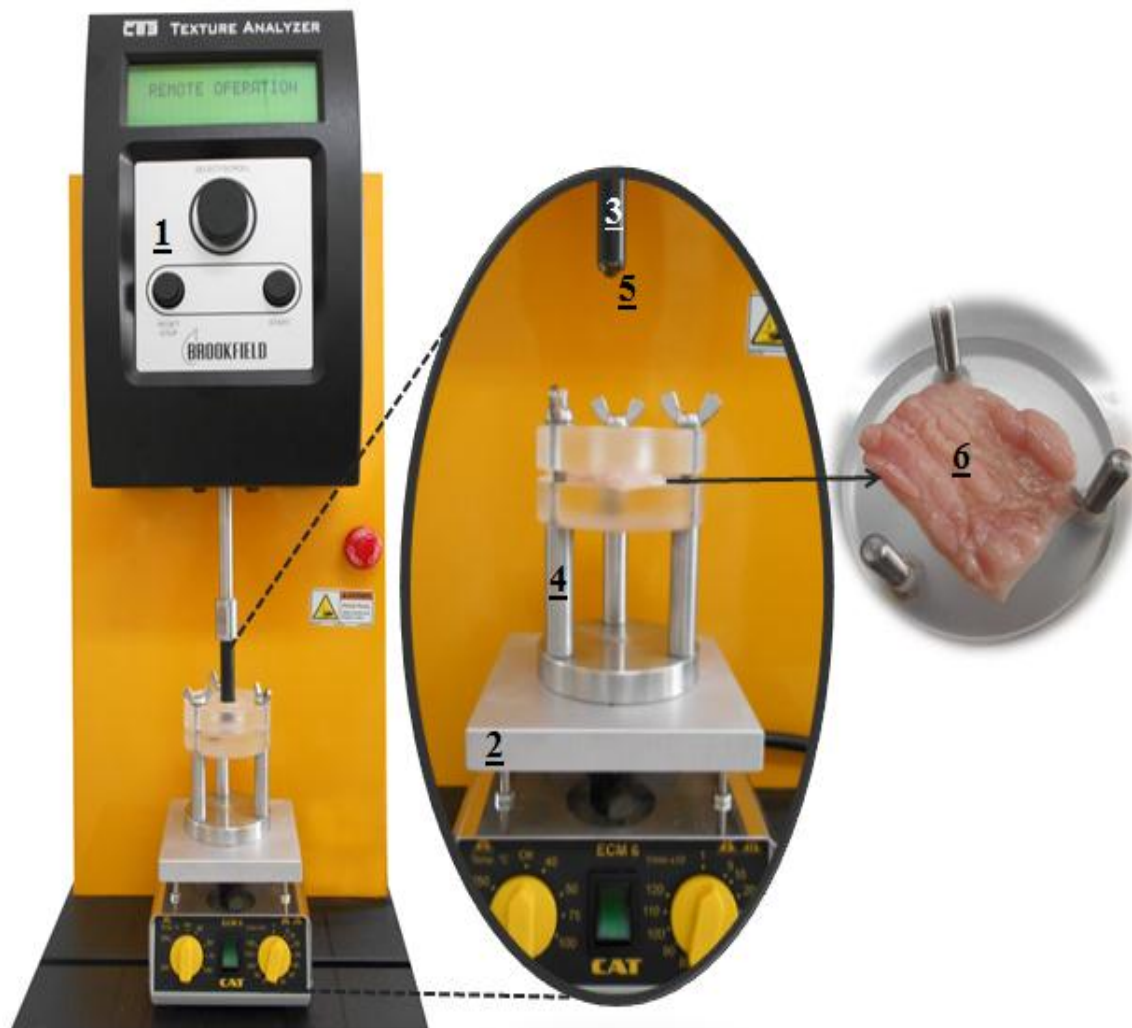
Figura 18. Equipo y tejido utilizado para fuerza de adhesión: 1) analizador de textura BrookfieldCT3, 2) soporte, 3) sonda cilíndrica, 4) módulo de bioadhesión, 5) muestra de gel, 6) vagina de cerda.
