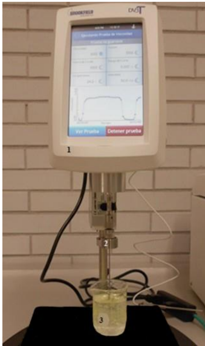
Figura 14. Equipo utilizado para medición de la viscosidad: 1) Reómetro DV3T Brookfield, 2) aguja, 3) gel.
