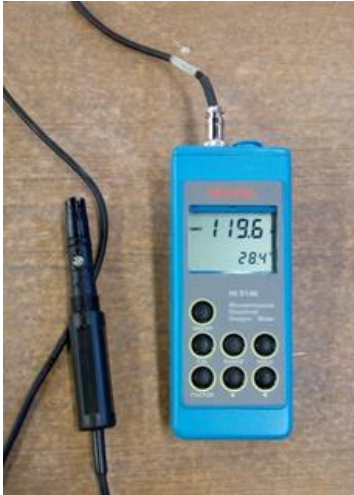
Figura 24.- Oxímetro y electrodo.
