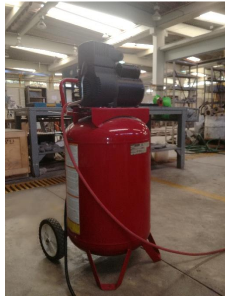
Figura 27. – Compresor de aire.
