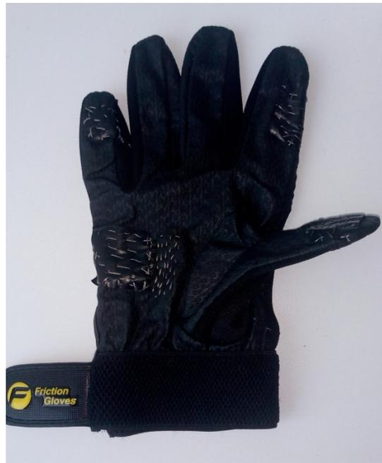
Ilustración 31 Sensores de contacto en el guante
