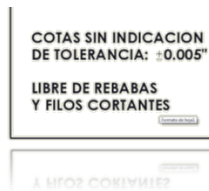
Figura 1.19 Indicación de tolerancia y filos cortantes. Fuente: Elaboración propia, 2019.
