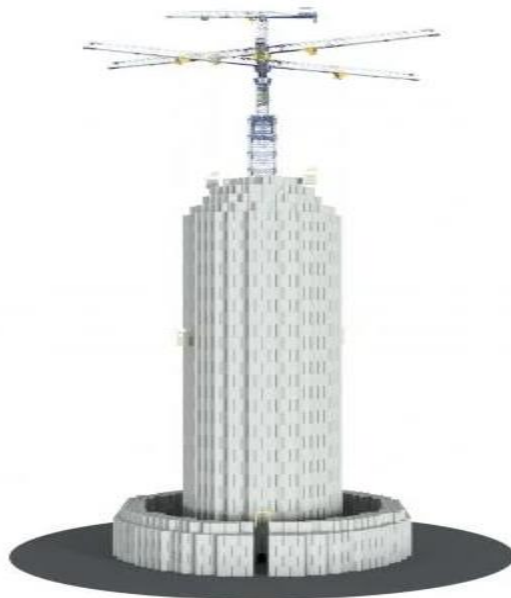
Figura 21. Torre de bloques de hormigón, sistema de almacenamiento [21].
