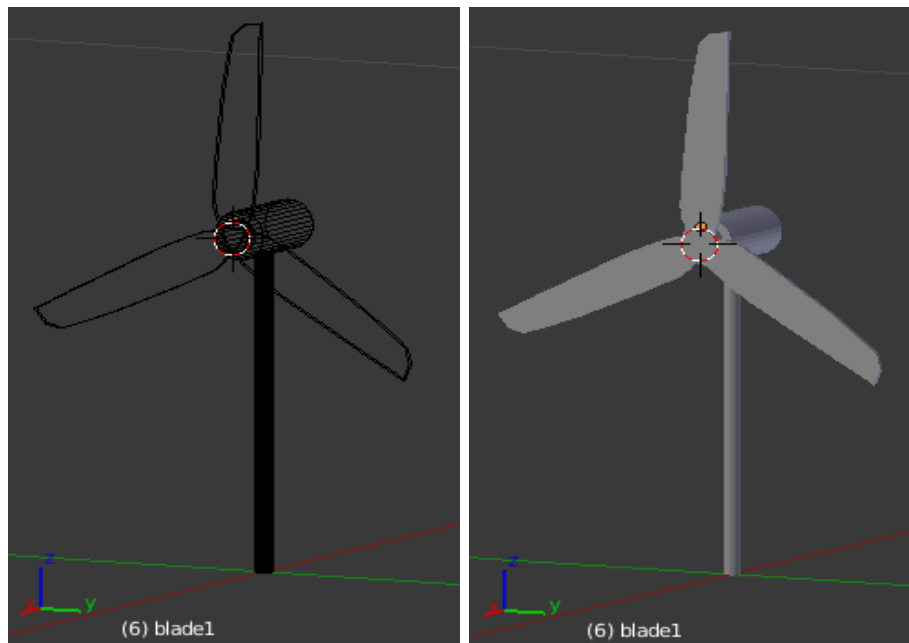
Figura 54. Turbina eólica para el caso de validación modelada en Blender .
