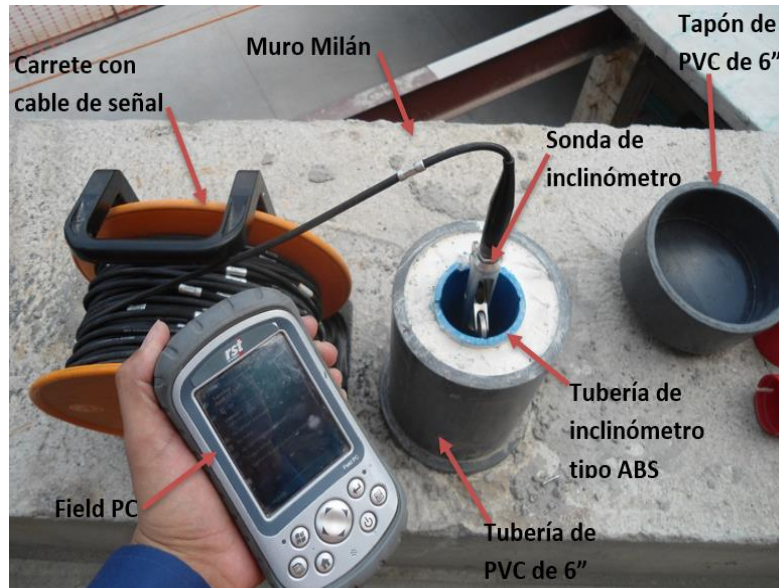
Figura 54. Elementos que integran el Inclinómetro vertical. Fuente: Cortesía del proyecto Marina 385
