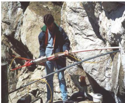
Figura 13. Extensómetro interno de barras y extensómetro externo de juntas y grietas (eléctrico). Fuente: Instrumentación y Monitoreo del comportamiento de Obras Hidráulicas
