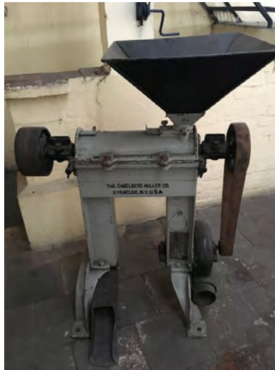
Despulpadora de Engelberg Huller & Co. en La Orduña (RHF, 2017) y lavador mecánico de café Wm Mc Kinnon & Co. ( http://mcjazz.f2s.com/FoundryWmMckinnon.htm )
