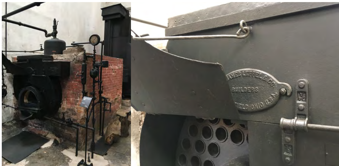
Caldera de 1925 para impulsar la maquinaria de las secadoras de café. Finca Roma. RHF, 2018. Secadora estadounidense marca Leffel & Co. Finca Roma. RHF, 2018.
