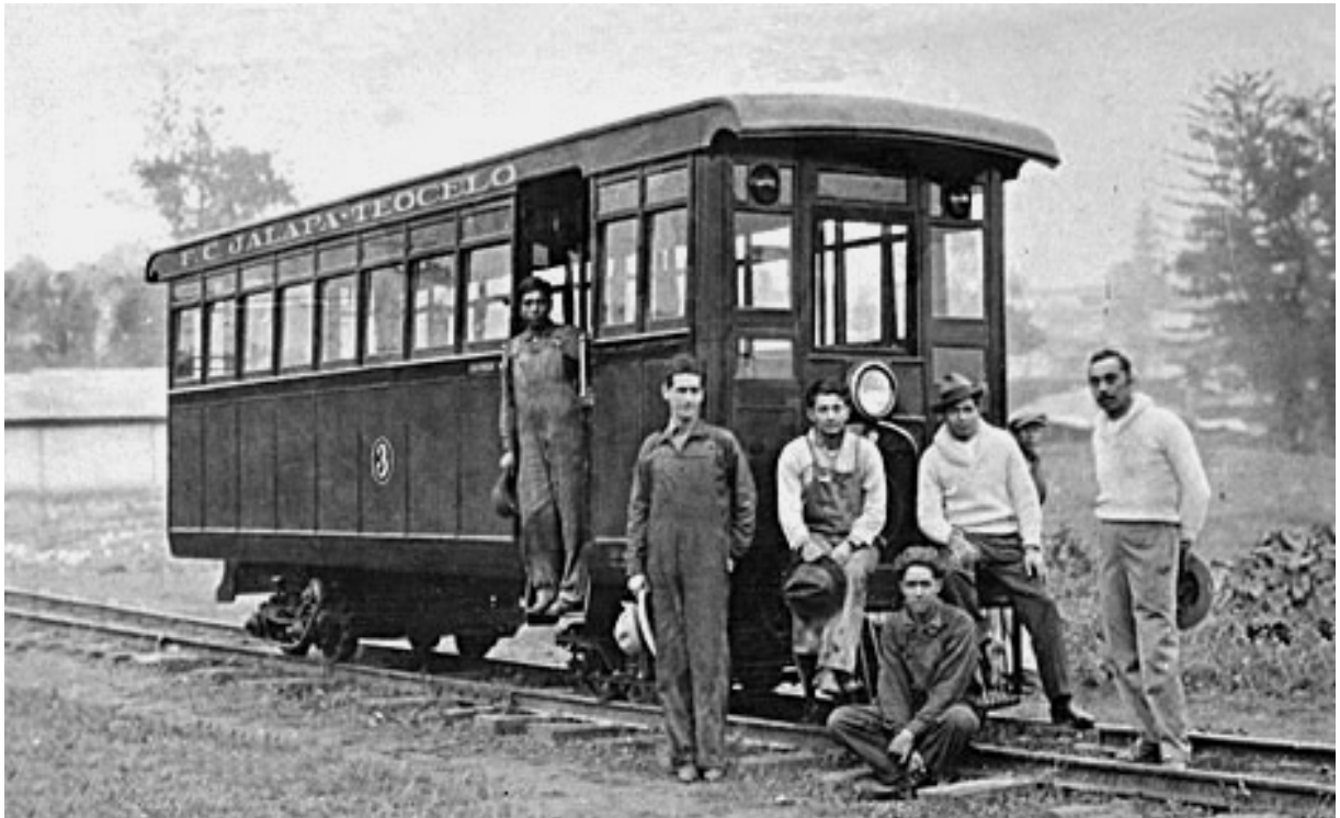
Tranvía de gasolina de la Jalapa Railroad & Power Co. Este vehículo es el "Autovía" que menciona el Sr. Mario Fernández que circuló entre Xalapa y Teocelo a partir de 1926. Colección Allen Morrison, 1927. En el costado superior del vagón está escrito: "F.C. JALAPA – TEOCELO". http://www.tramz.com
