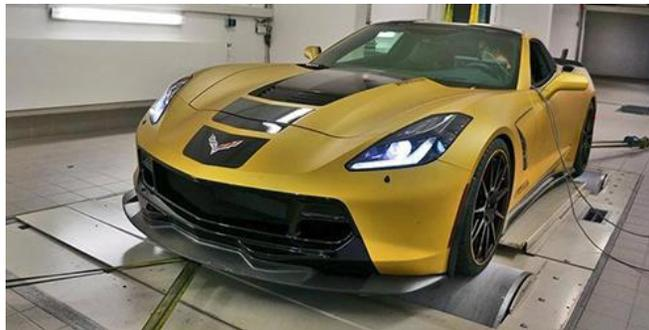
Figura 1.2 Dinamómetro de chasis manufacturado por SuperFlow [2].
