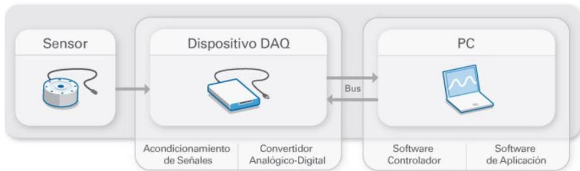
Figura 2.7. Partes de un sistema DAQ [7].
