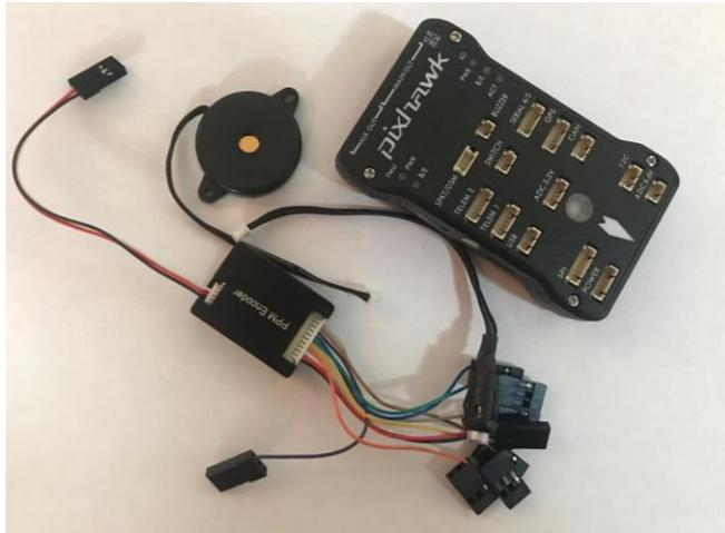
Figura 83. Componentes de la Pixhawk [Fuente: Oscar T. Sánchez Vite (2019)].
