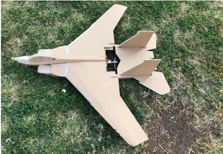
Figura 97. Avión con mayor superficie alar [Fuente: Oscar T. Sánchez Vite (2019)].
