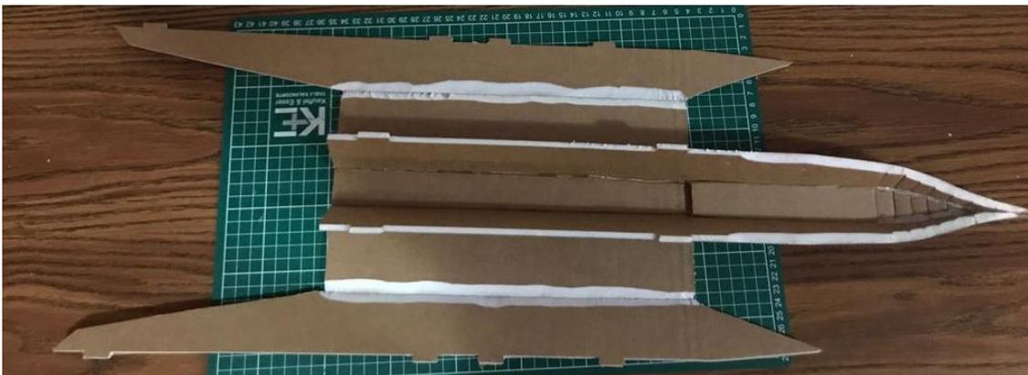
Figura 50. Unión de la punta del Fuselaje [Fuente: Oscar T. Sánchez Vite (2019)].
