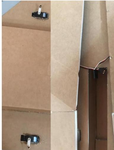
Figura 64. Colocación de los servomotores en los alerones [Fuente: Oscar T. Sánchez Vite (2019)].
