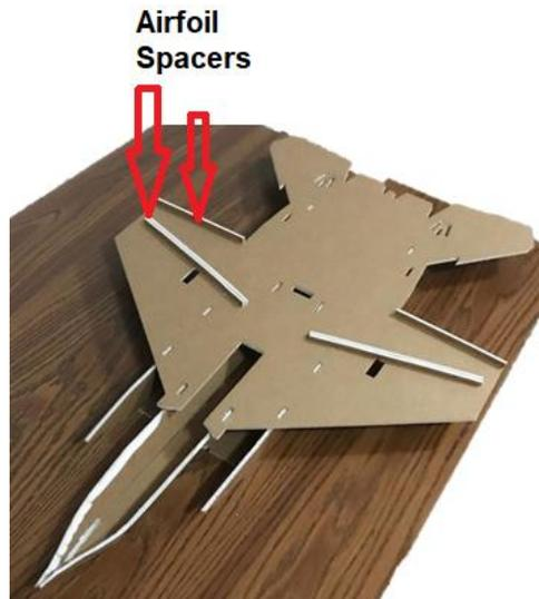
Figura 52. Colocación de los espaciadores [Fuente: Oscar T. Sánchez Vite (2019)].
