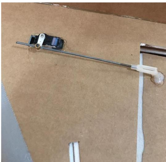
Figura 66. Colocación de la varilla y horns [Fuente: Oscar T. Sánchez Vite (2019)].
