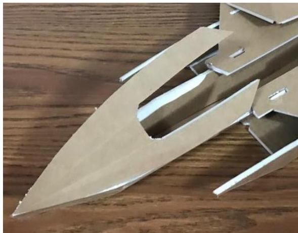
Figura 59. Colocación de la nariz del fuselaje [Fuente: Oscar T. Sánchez Vite (2019)].
