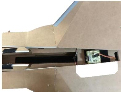
Figura 68. Velcro en el interior del Fuselaje [Fuente: Oscar T. Sánchez Vite (2019)].
