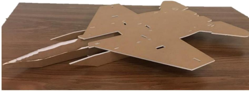
Figura 51. Unión de las alas y elevador con el fuselaje [Fuente: Oscar T. Sánchez Vite (2019)].
