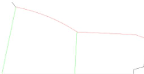
Figura 53. Líneas Rojas cortar a 45°. Líneas verdes cortar la primera capa de papel y foamboard [Fuente: Oscar T. Sánchez Vite (2019)].
