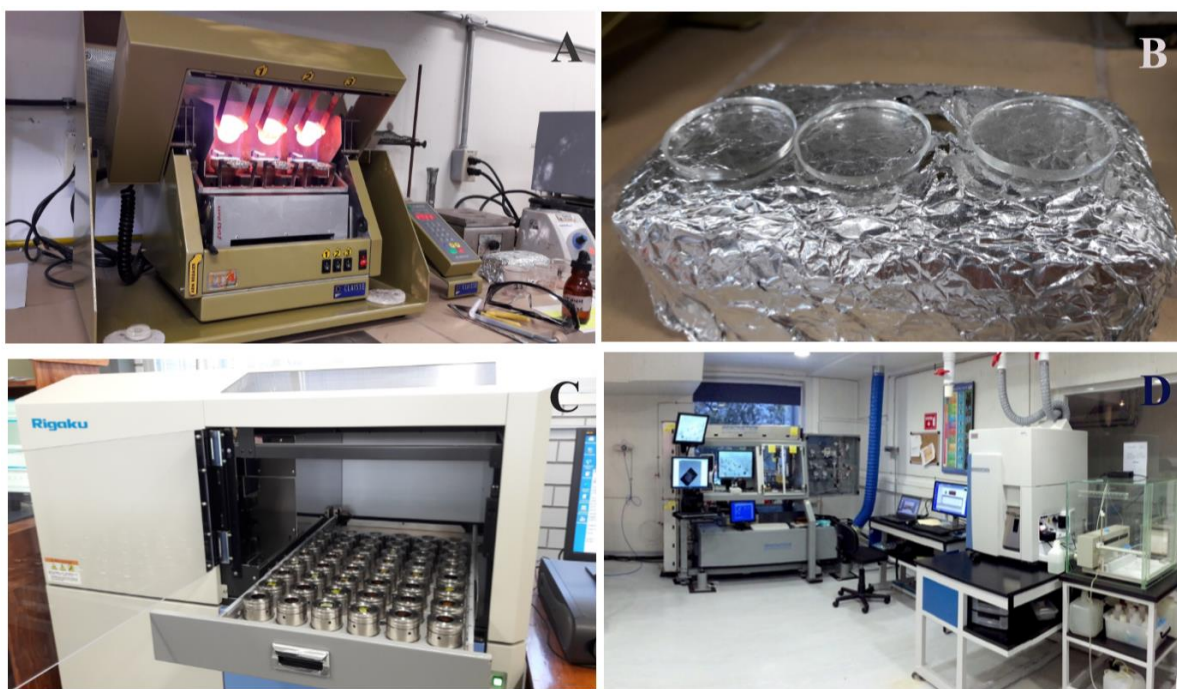
Figura 3.3 En la imagen A se observa el fundido al rojo vivo de la muestra y en la imagen B se observa la perla fundida resultado de este procedimiento, en esta perla es donde se realizan las mediciones correspondientes en el espectrómetro de Rayos X que se observa en la imagen C. Por último, en la imagen D se observa el laboratorio de estudios isotópicos (LEI) del Centro de Geociencias, UNAM en el que se realizaron las mediciones para elementos traza.
