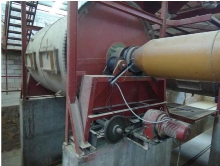
Figura 31. Tambor rotativo para secado de café.
