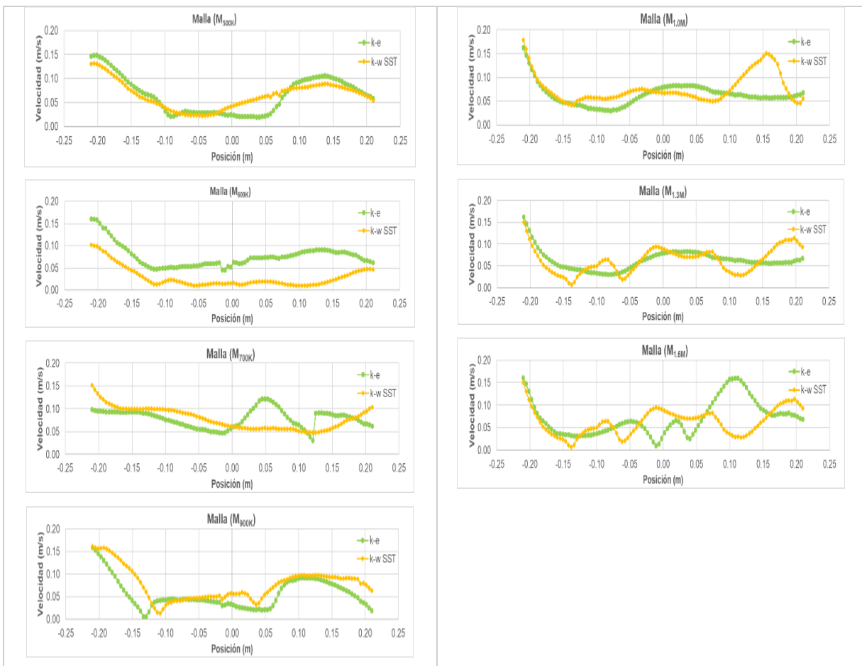
Figura 54. Perfiles de velocidad para diferentes modelos de turbulencia y tamaño de malla (Caso 1 en dirección “x”).
