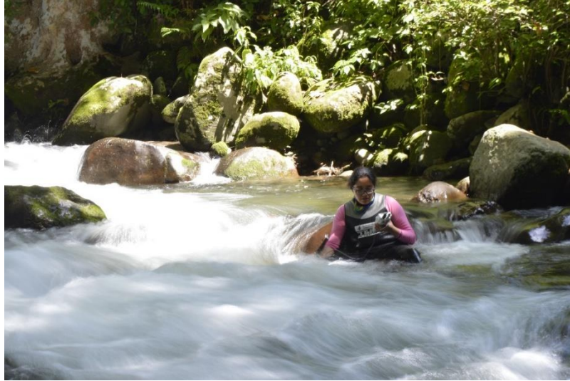
Figura 7. Medición de la conductividad eléctrica del agua del río en uno de los sitios de observación (margen izquierda de la corriente, vista aguas abajo; julio 2017).
