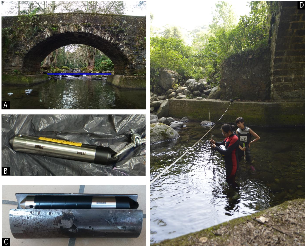
Figura 5. (A). Sección transversal. (B) Barómetro. (C) Limnógrafo. (D) Mediciones de la profundidad del río sobre la sección transversal (Mayo 2017).
