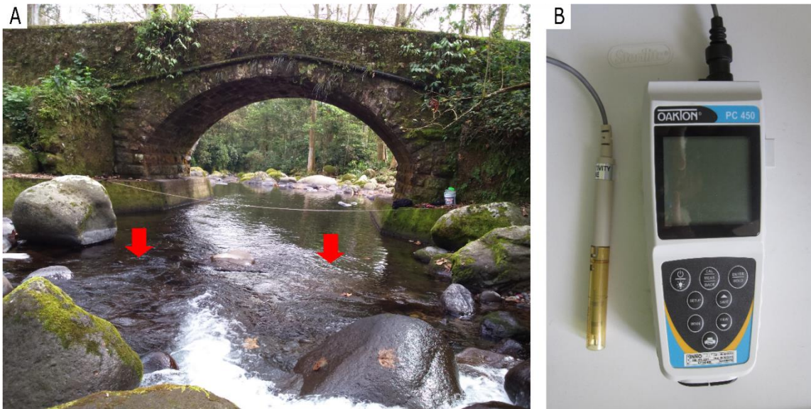
Figura 6. (A) Sitios de medición de la conductividad eléctrica indicado con las flechas rojas, vista aguas abajo, enero 2016. (B) Multiparamétrico empleado para medir la conductividad eléctrica en el río.
