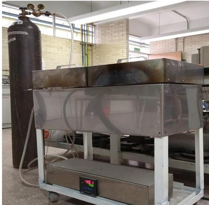
Figura 22. Horno horizontal de resistencia utilizado para el proceso de sinterización.
