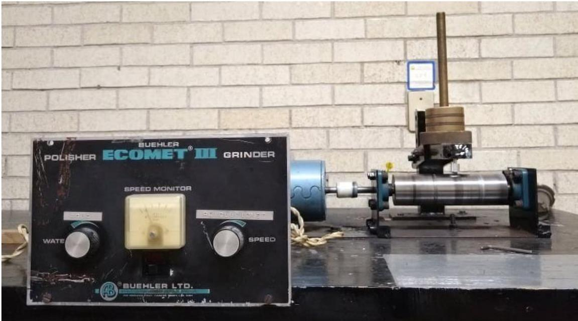
Figura 24. Sistema tribológico para el ensayo de desgaste.
