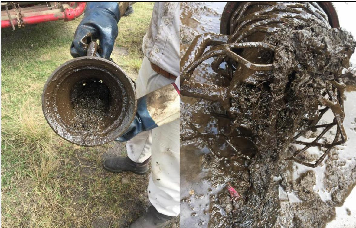
Figura 3.3.4-3 Taponamiento en tubería por cuerpos en lodo de perforación, pozo letrina Arquimia. Fuente: Pemex (2019)
