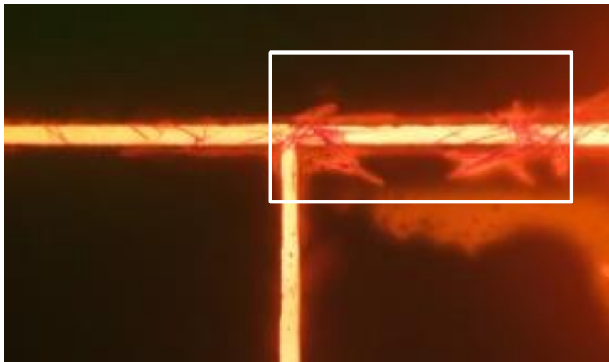
Figura 17. Microscopía de fluorescencia de una disolución de rojo nilo en hexadecano dentro de sistema de microcanales de PDMS tratado con H_2SO_4 . Se pueden observar zonas rugosas (rupturas), marcadas con un recuadro blanco, cercanas a los microcanales debido al tratamiento aplicado.
