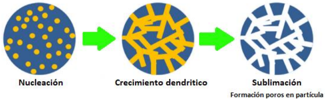
Figura 32. Ilustración de la formación de canales de poros interconectados en una MPP mediante el uso de canfeno. En la etapa de nucleación se distribuye el canfeno en la microgota, al comenzar a solidificar se forman dendrímeros o redes del compuesto que al sublimarse genera los poros interconectados.
