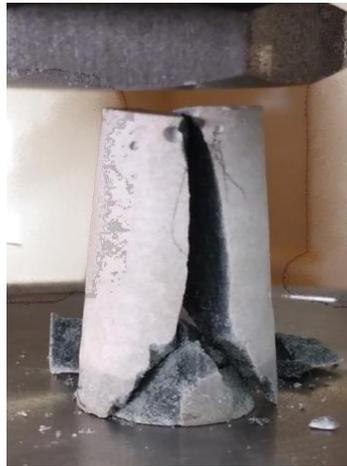
**Figura 9.** Modo de fractura de la probeta CGP 8 sometida a esfuerzo de compresión.
