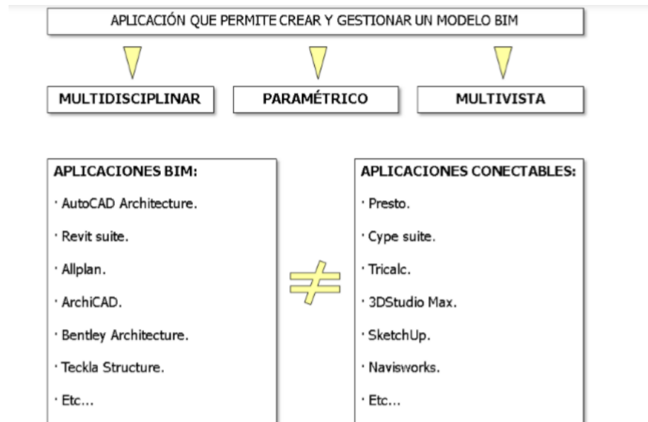
Figura No 7- Esquema para diferencias entre herramientas BIM y Aplicaciones conectables
