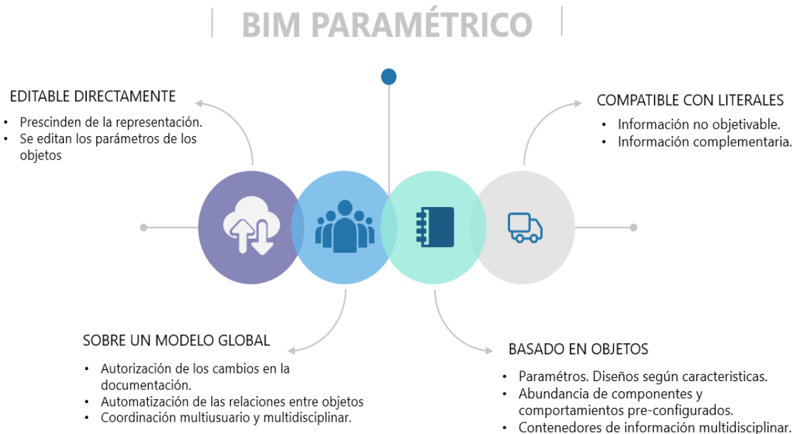
Figura No 5- Esquema que explica la relación paramétrica que maneja BIM.
